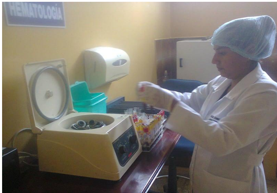
Fotografía 8. Proceso de centrifugación de muestras sanguíneas para la obtención de suero
