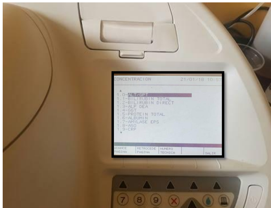
Fotografía 10. Selección de la prueba a realizar en el Analizador de bioquímica semiautomático BTS-350
