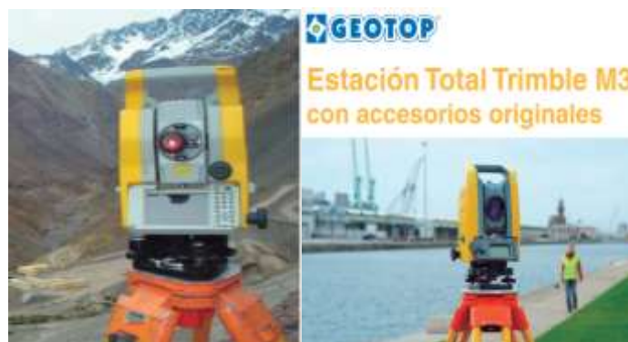
FIGURA 16: Estación Total Utilizada en las Mediciones de Campo.
