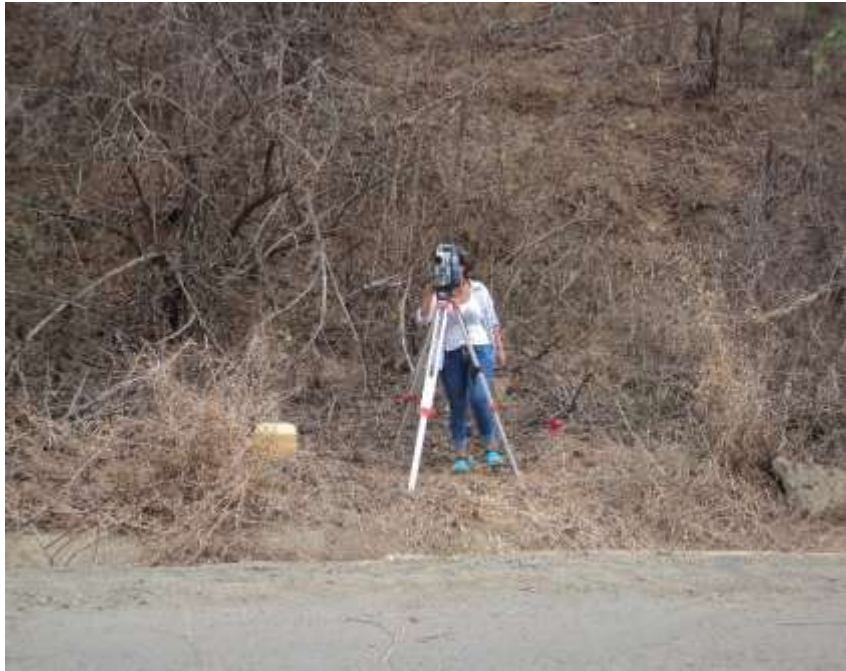
Imagen 30. Levantamiento Topográfico de la Vía en Estudio.
