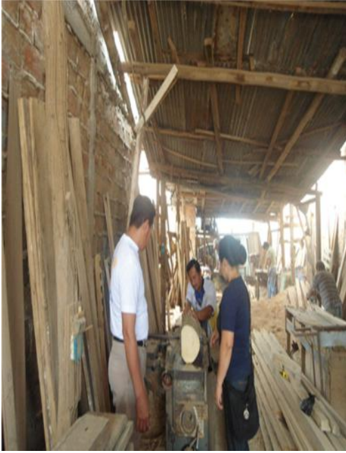
Foto 5 y 6. Seccionamiento para elaboración de probetas.
