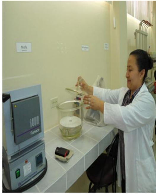
Foto 9 y 10. Toma de datos para determinar el contenido de humedad.
