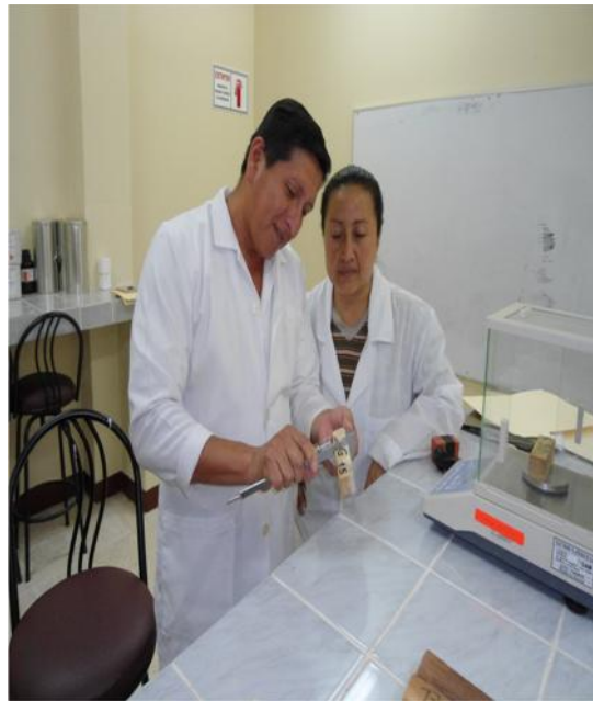
Foto 13 y 14. Toma de datos para determinar contracciones en la madera.
