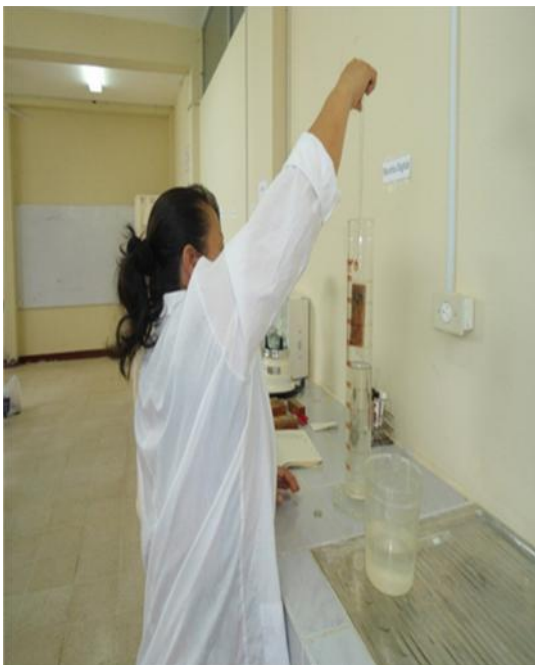
Foto 15 y 16. Determinar el peso específico mediante proceso de inmersión en agua.
