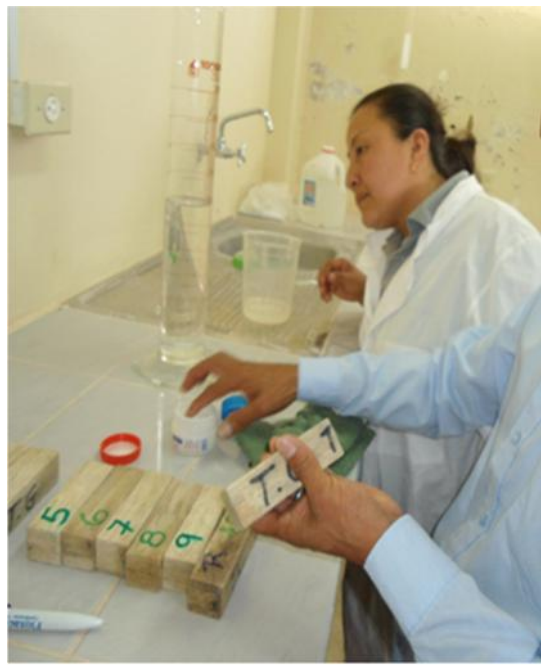
Foto 15 y 16. Determinar el peso específico mediante proceso de inmersión en agua.
