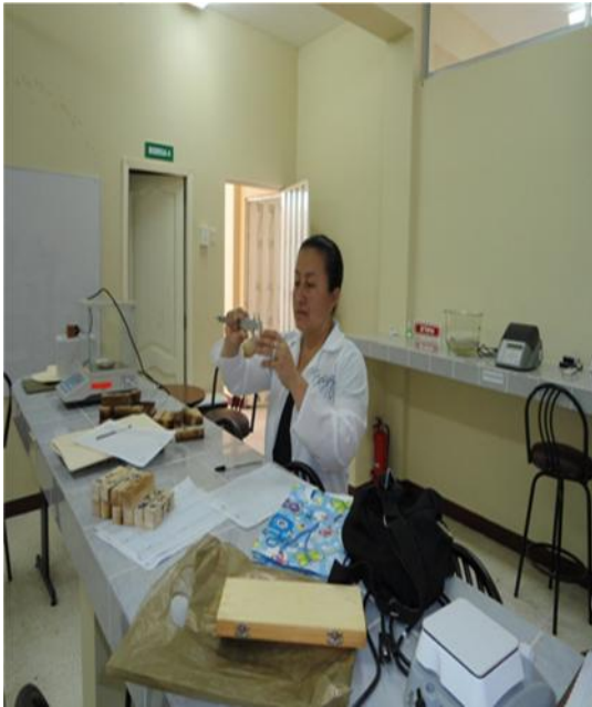
Foto 13 y 14. Toma de datos para determinar contracciones en la madera.
