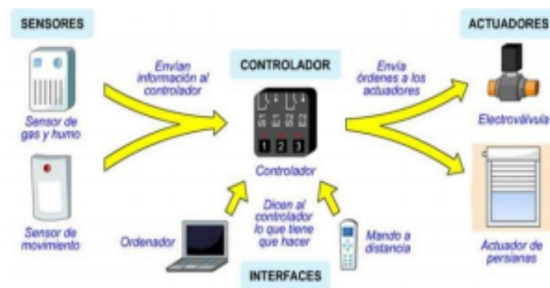
Ilustración 4. Componentes de un sistema domótico centralizado
